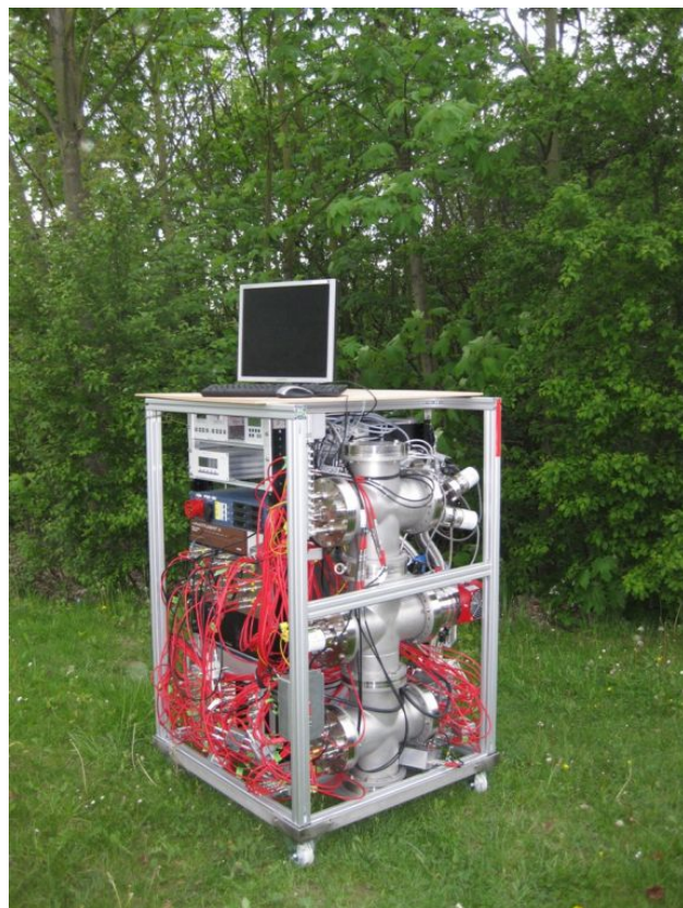
Abbildung 5 Aufbau des MR-TOF-MS im AmbiProbe-Projekt (links schematisch, rechts Photo), Bild aus [L + 12]
